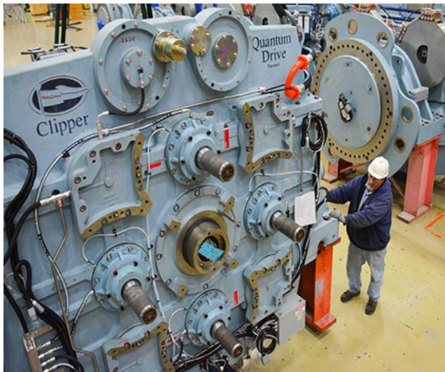
Figura 7-2 - DriveTrain Split para 04 geradores Quantum Drive™.
