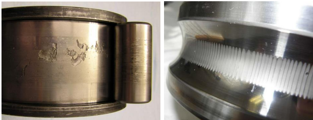
Figura 3-11 - Desgastes em rolamentos de uma caixa de velocidade.
