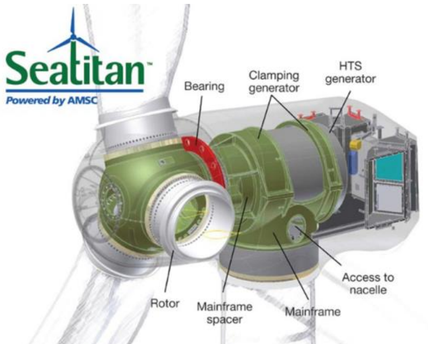
Figura 7-12 - Turbina Eólica HTS SeaTitan™.
